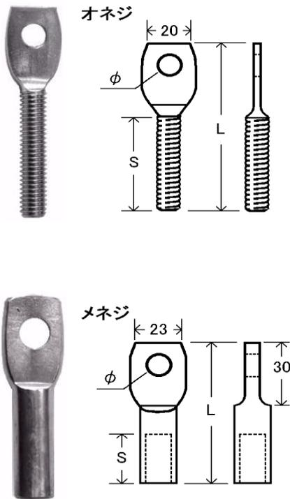
特長 1. 吊タンバックル及び全ネジを使用せず、固定タンバックルを使用することにより、配管の高低調整が簡単におこなえます。
