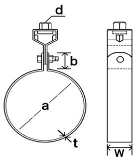
ステンレス (SUS430) 製 ※ ボルト、ナット、タンバクルはSUS304製
